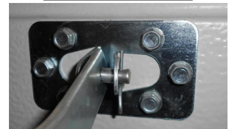
15. Ábra. Motor kar rögzítő konzol
